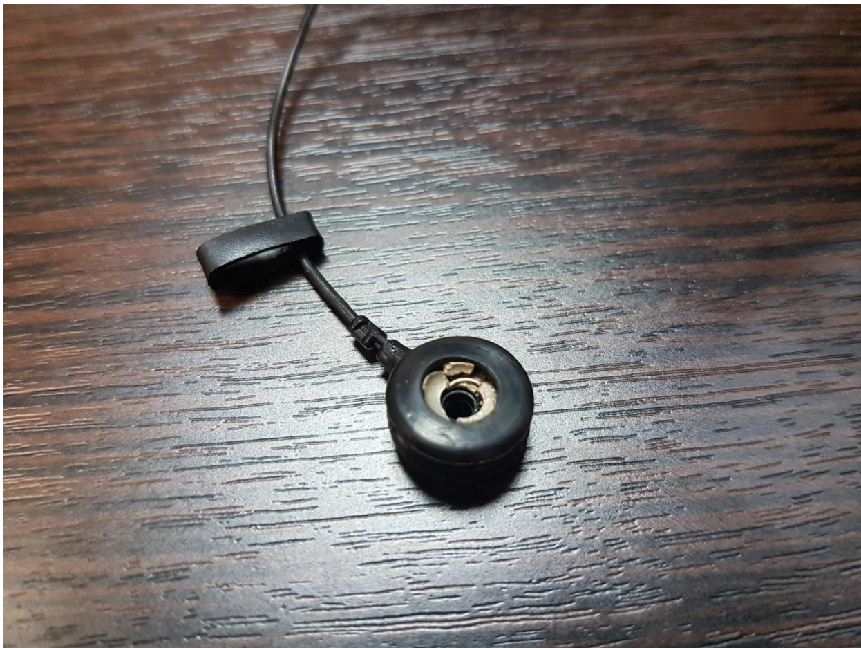
Рисунок 58. Электрод с механическими повреждениями.
