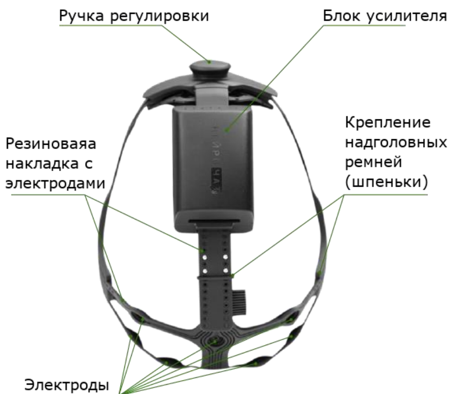
Рисунок 22. Схема нейрогарнитуры «ГарАнт-ЭЭГ».
