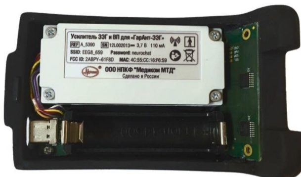
Рисунок 24. Блок усилителя нейрогарнитуры без аккумуляторной батареи и нижней крышки.
