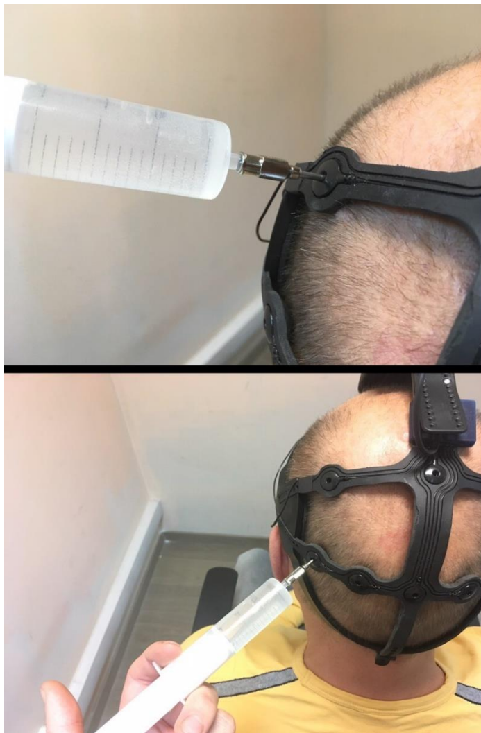
Рисунок 30. Добавление токопроводящего геля в подэлектродную область при помощи специального шприца через отверстие сверху электрода.
